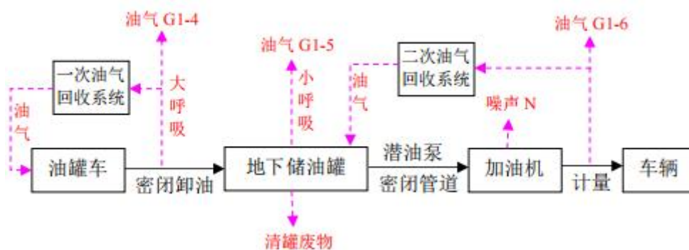
图 2.4-2 汽油卸油及加油工艺流程及排污节点图
