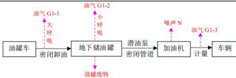
图 2.4-1 柴油卸油及加油工艺流程及排污节点图
