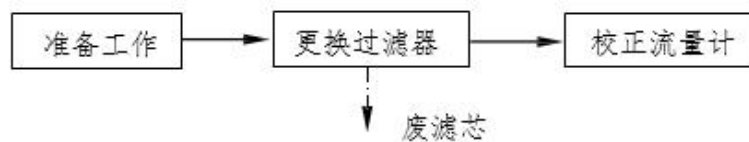
图 2.4-5 加油机检修工艺流程及排污节点图
